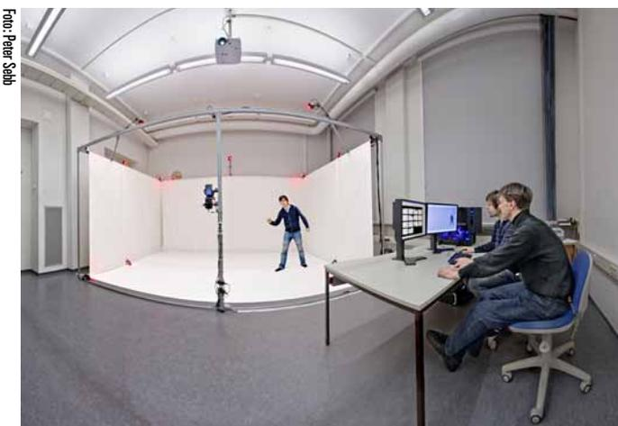
Abbildung 1: Das markerlose Motion-Capture-System der HTW Dresden.
